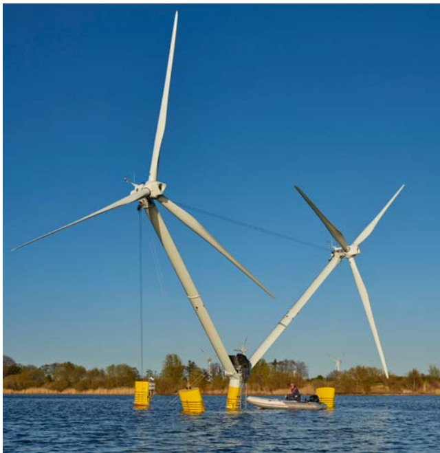
Aufbau und Test des Modells der schwimmenden Windenergieanlage „Nezzy 2“ (Maßstab 1:10) in Hymendorf in Niedersachsen. Foto: Jan Oelker
