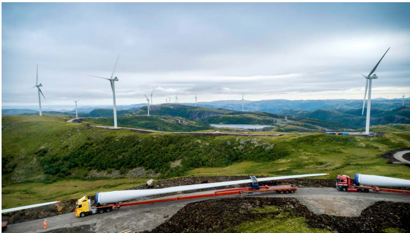
Jedes Blatt der Vestas V117 ist 57,2 m lang, während die Blattlänge des V112-Rotors 54,7 m beträgt. Foto: Statkraft/Ole Martin Wold
