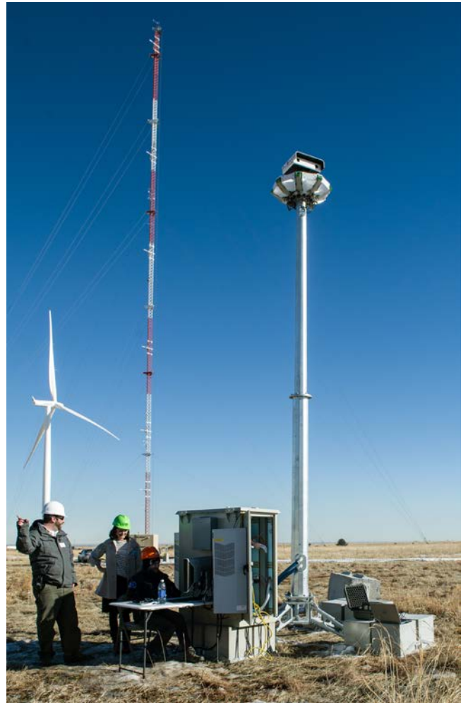
Das Kamerasystem Identiflight kann Vögel nicht nur bis zu einem Kilometer entfernt erkennen, sondern auch die Art identifizieren. Foto: Dennis Schroeder/NREL
